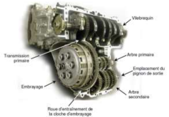
Figure 6 : Architecture générale d'une boîte de vitesses de motocyclette
