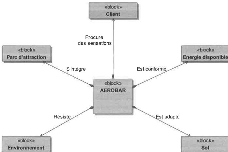
Figure 2 – Diagramme SysML de contexte de l'AEROBAR
