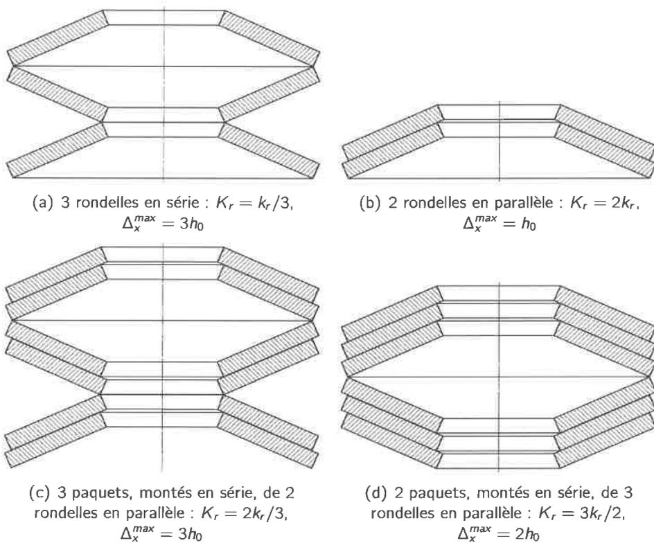
**Figure 21** – Exemples d'empilements de rondelles élastiques de raideur unitaire  $k_r$  et de hauteur  $h_0$  ; la raideur de l'empilement  $K_r$  et l'écrasement maximal possible  $\Delta_x^{max}$  sont donnés pour chaque empilement
