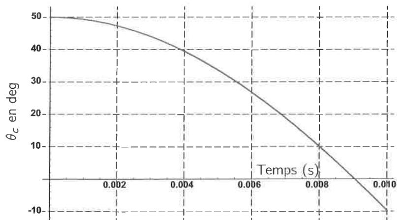
Figure 17 – Angle  $\theta_c$  du crochet après rupture du câble de traction à  $t = 0$
