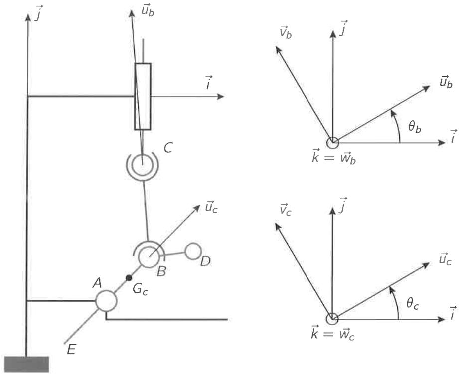
**Figure 18** – Représentation du système antichute durant la phase transitoire entre les états présentés sur les figures H.14(a) et H.14(b) de l'annexe H ;  $\vec{AB} = l_c \vec{u}_c$ ,  $\vec{AG}_c = a_c \vec{u}_c$ ,  $\vec{BC} = l_b \vec{u}_b$ ,  $\vec{AC} = \delta_n \vec{i} + \lambda_t \vec{j}$
