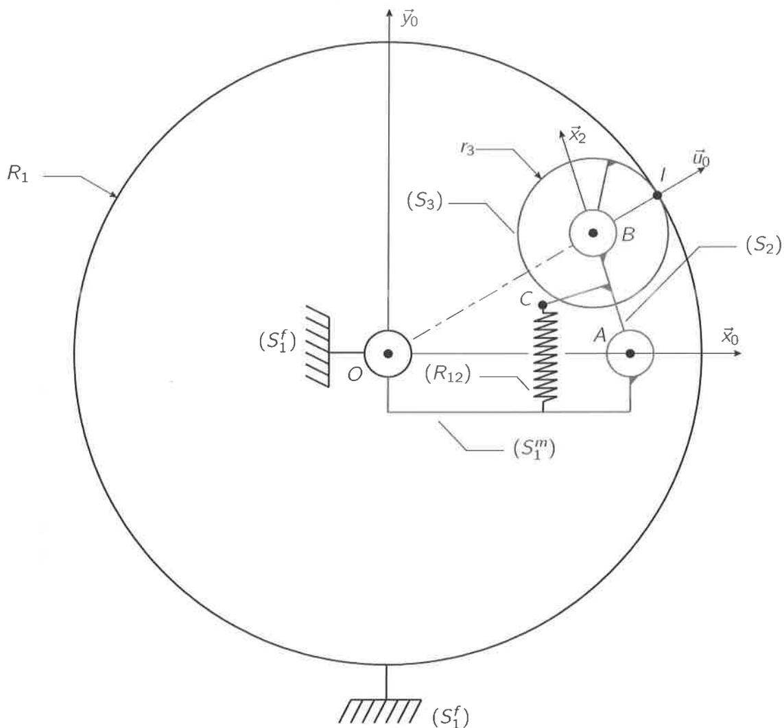
**Figure 24** – Schéma d'architecture du système d'entraînement de la nacelle ; les positions des différents points sont données par :  $\vec{AB} = l_2 \vec{x}_2$ ,  $\vec{AC} = a_2 \vec{x}_2 + b_2 \vec{y}_2$ ,  $\vec{BI} = r_3 \vec{u}_0$ ,  $\vec{OI} = R_1 \vec{u}_0$
