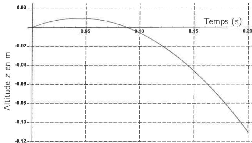
Figure 16 – Position de la nacelle après rupture du câble de traction à  $t = 0$
