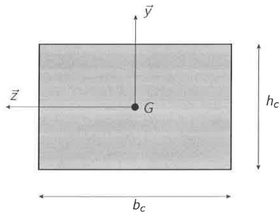
**Figure 23** – Géométrie de la section du crochet
