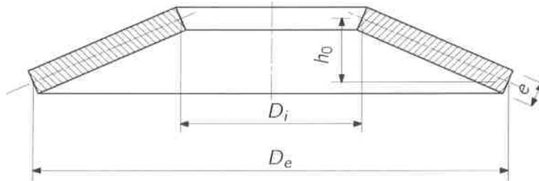
Figure 19 – Géométrie d'une rondelle élastique SCHNORR
