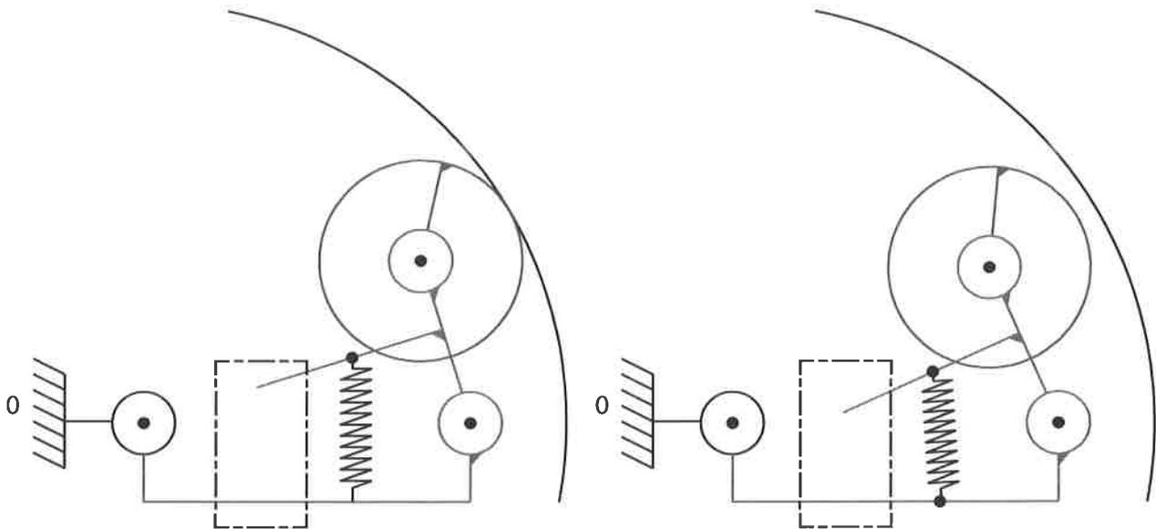
(a) Système en phase de fonctionnement normal : le ressort plaque la roue contre le fût
