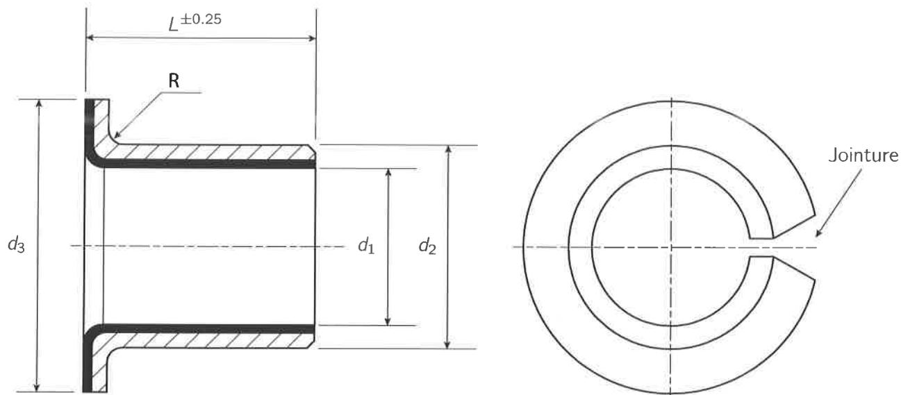
**Figure 29** – Géométrie des coussinets acier/PTFE à colerette retenus
