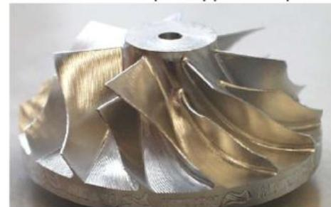
Exemple de pièce complexe obtenue par usinage
