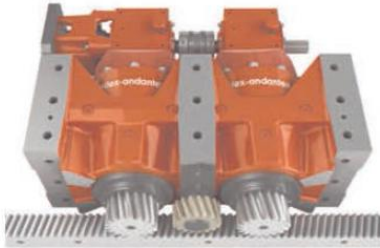
Figure 1 – Photo d'une boîte d'avance DualDRIVE du type de celle étudiée dans le présent sujet (source Redex)
