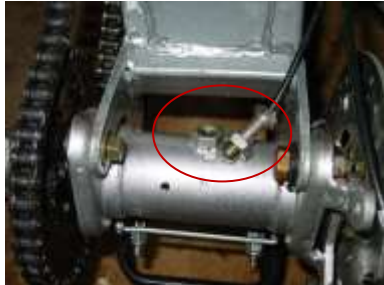
Graisseur intégré pour lubrification boîtier à roulements
