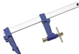
La partie mobile du serre joint s'arc-boute sur le guide au serrage.
