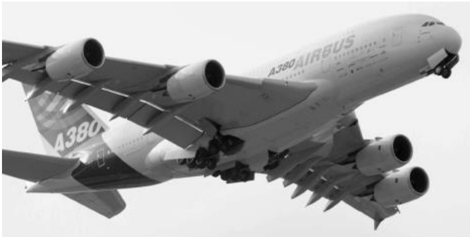
Figure 3 : sortie des trains d'atterrissage sur l'A380
