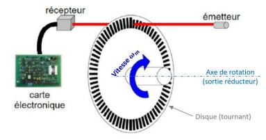
Un disque est fixé sur l'arbre tournant. Des fentes sont réparties sur la périphérie du disque.
