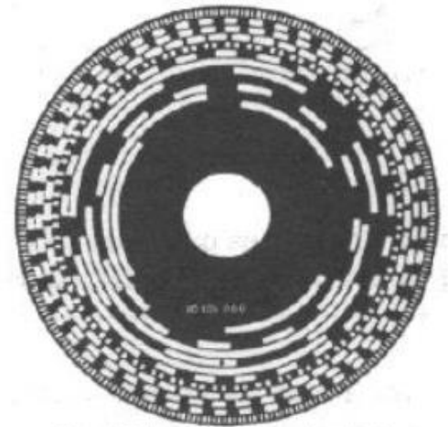
Disque 12 pistes d'un codeur optique absolu
