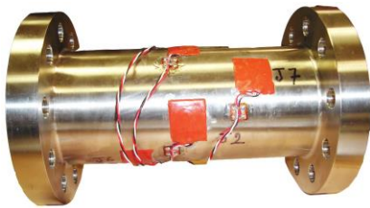
Jauges placées sur un manchon d'accouplement
