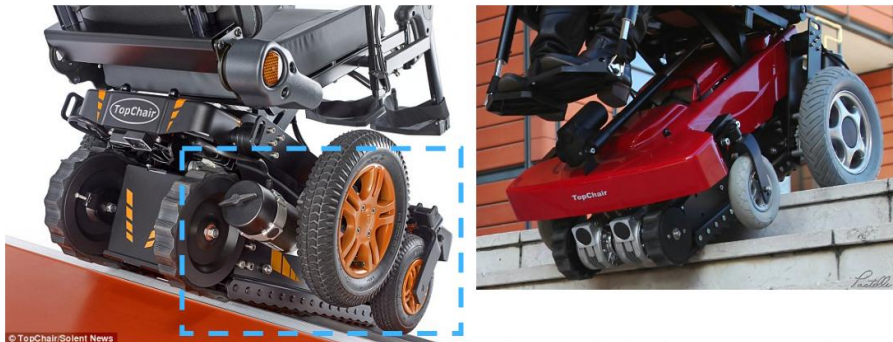
© TopChair/Scient News Système d'escamotage : fauteuil roulant électrique TopChair – S en mode «escaliers»
