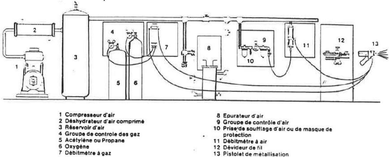
Le pistolet métalliseur est constitué d'une part, d'un chalumeau fonctionnant avec de l'acétylène et de l'oxygène et d'autre part, d'un dispositif permettant de conduire le fil vers la buse du chalumeau à vitesse de défilement réglable. Seul le dispositif d'amenée du fil est représenté sur le dessin d'ensemble et sera objet de l'étude.
