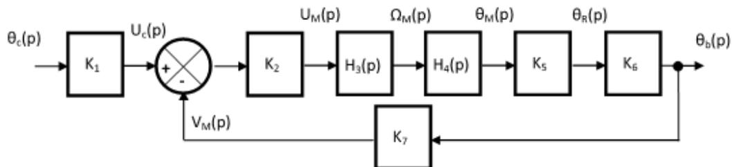
Avec :  $K_1, K_2, K_5, K_6, K_7$  : constantes,  $\theta_c(p)$  : angle de consigne,  $U_c(p)$  : tension consigne,  $U_M(p)$  : tension moteur,  $\Omega_M(p)$  : vitesse angulaire de l'arbre moteur,  $\theta_M(p)$  : angle de l'arbre moteur,  $\theta_R(p)$  : angle de l'arbre en sortie de réducteur,  $\theta_b(p)$  : position angulaire du bras,  $V_M(p)$  : tension mesurée image de  $\theta_b(p)$ .
