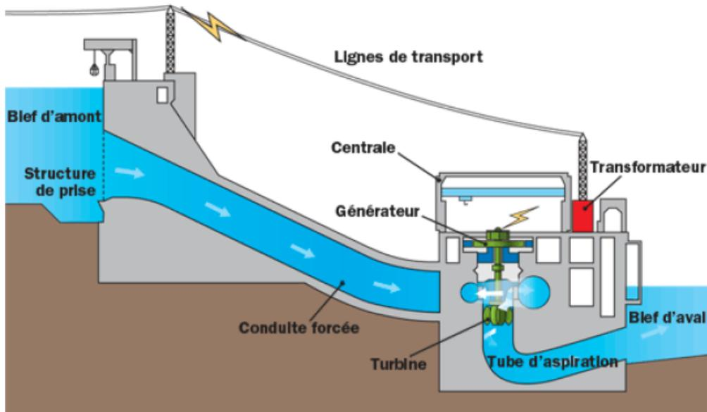
L'hydroélectricité est produite dans des usines hydrauliques couplées avec des barrages. La force motrice de l'eau est captée pour produire de l'électricité.
