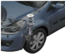
Amortisseur d'un véhicule automobile
