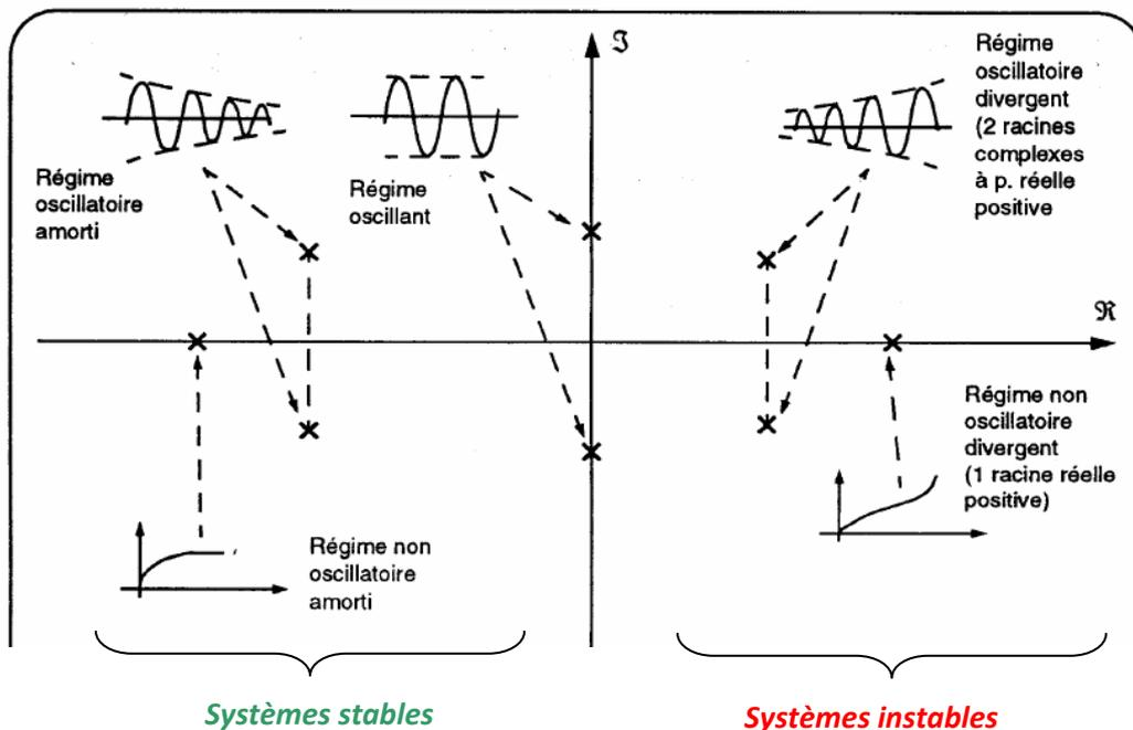
La sortie  $s(t)$  n'est stable que si les racines du dénominateur de la fonction de transfert (pôles de la fonction de transfert) sont tous à partie réelle négative.
