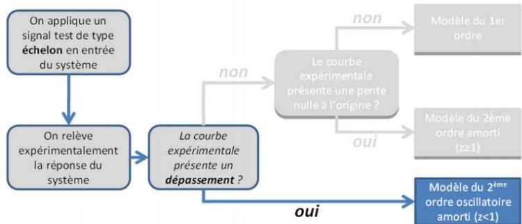
Dans le cas d'une **réponse à un échelon avec dépassement**, les caractéristiques du 2<sup>ème</sup> ordre sont identifiées ainsi :
