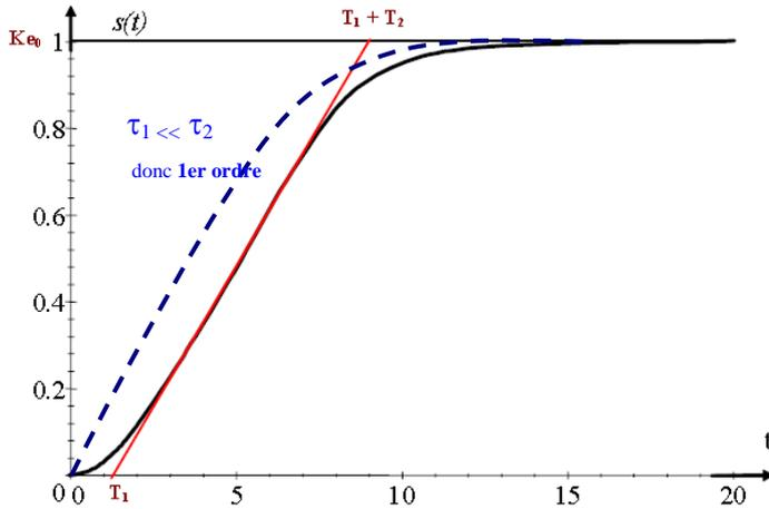
On trace la tangente au point d'inflexion et l'intersection de cette tangente avec l'axe des abscisses et l'asymptote horizontale, donnent les valeurs  $T_1$  et  $T_2$ .
