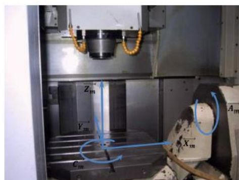
Axes normalisés sur un centre d'usinage 5 axes
