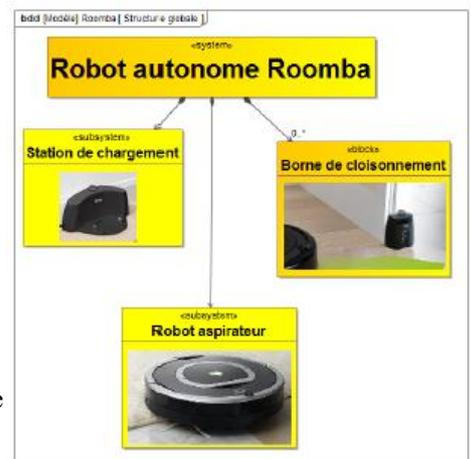
Dans une première approche, la structure du système peut être présentée comme ci-contre. L'indication « 0..\* » indique que le système peut comprendre 0 borne de cloisonnement, ou plus.
